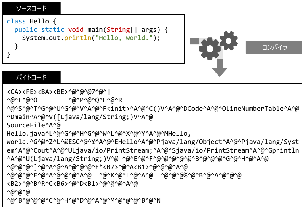
図2 ソースコードをコンパイルして得られるバイトコードの例
