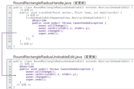
図 14 匿名クラス内のメソッド undo() が通常クラス内に移動する例
